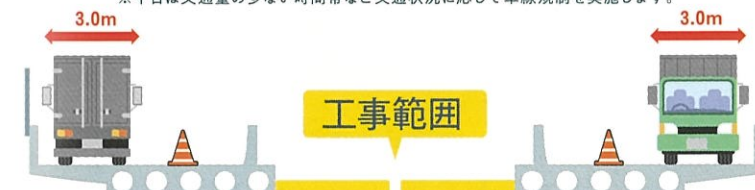
幅員減少規制+車線規制 断面図
