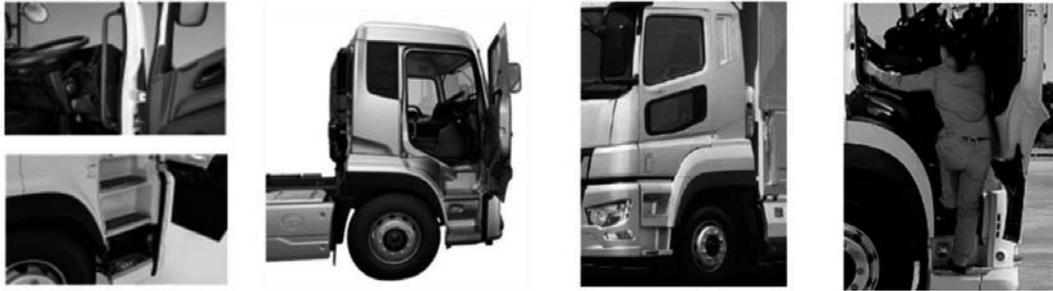
図 三点支持の確保のための取手やステップの例
