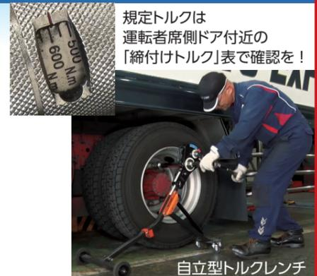
トルクレンチを使って規定トルクで正しい締め付け
